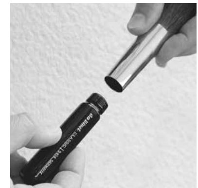
8. Aufleimen des Pinselkopfes auf den Stiel Glueing the brush-head onto the handle
