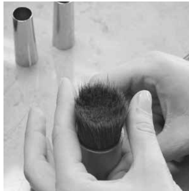
2. Stoßen des Haargutes in einer Messingbüchse Tapping of the hair upside down in a brass cup
