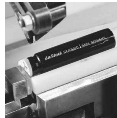
7. Stempeln der Holzstiele Stamping the wooden handles
