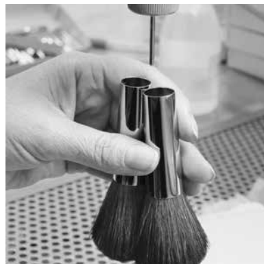
5. Verleimen der Haare in die Zwingen Glueing the hair into the ferrule
