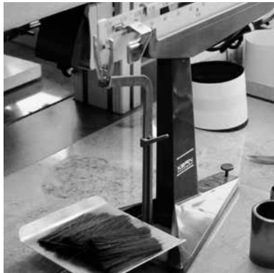
1. Portionieren und Abwiegen der Haare Portioning and weighing of the hair
